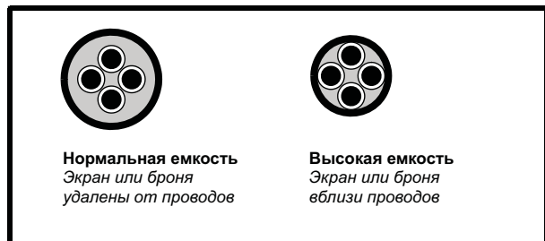
Рис. 4-13 Конструкция кабеля влияет на его емкость
